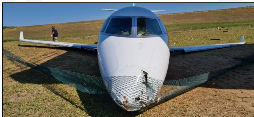
Figura 6 - Detalhe da cerca contra a qual a aeronave colidiu após a saída da pista.
