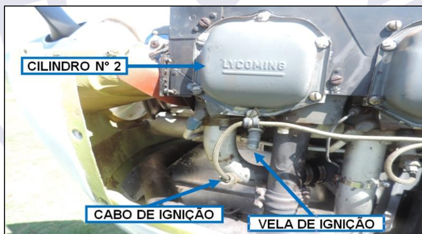
Figura 2 - Cabo de ignição inferior do cilindro nº2 não fixado.
