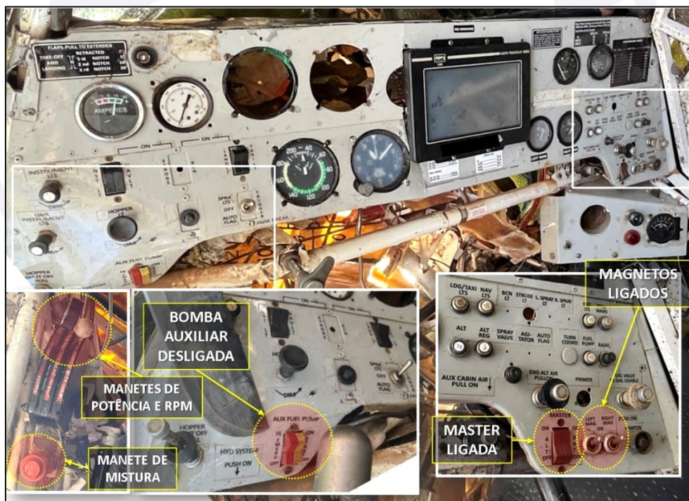
Figura 4 - Detalhe do painel da aeronave após a ocorrência.
