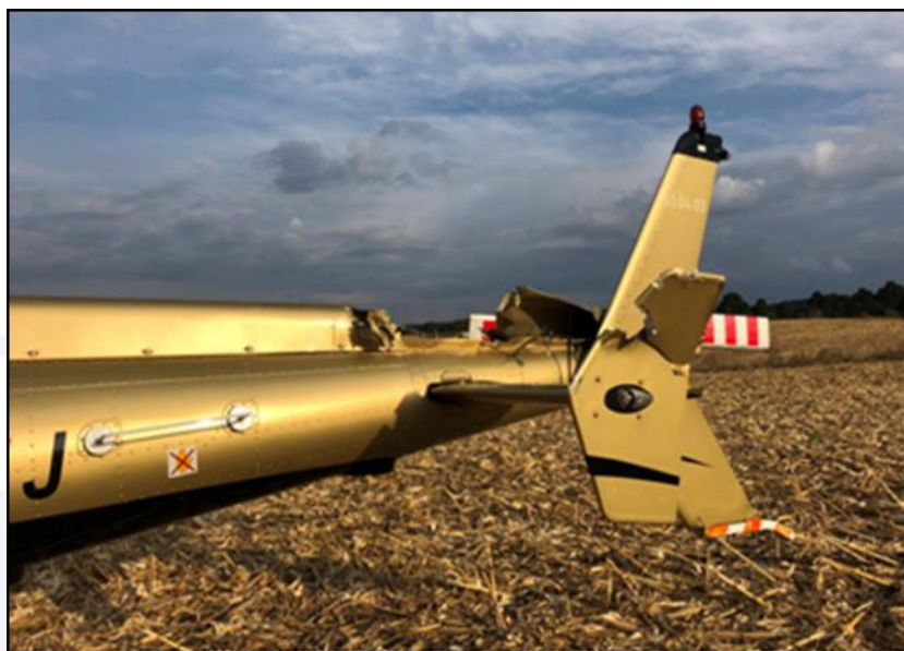
Figura 2 - Danos ao cone de cauda e ao estabilizador horizontal da aeronave.
