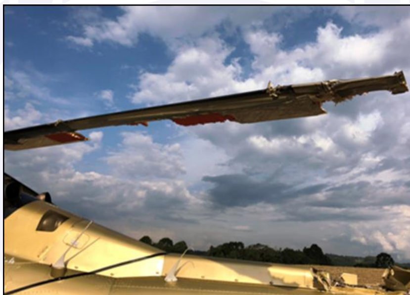
Figura 3 - Danos às pás do rotor principal.
