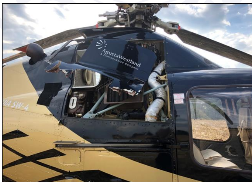
Figura 4 - Danos à porta da carenagem da transmissão do lado direito.
