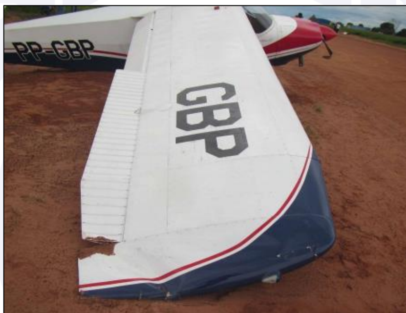
Figura 3 - Vista dos danos à asa direita.
