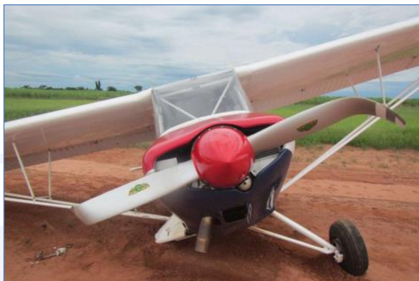
Figura 2 - Vista dos danos às pás da hélice e ao trem de pouso.
