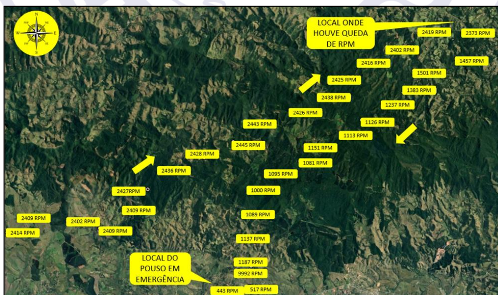
Figura 14 - Trajetória pictorial percorrida pelo PP-ZEZ no dia do acidente, com destaque para a RPM do motor.
