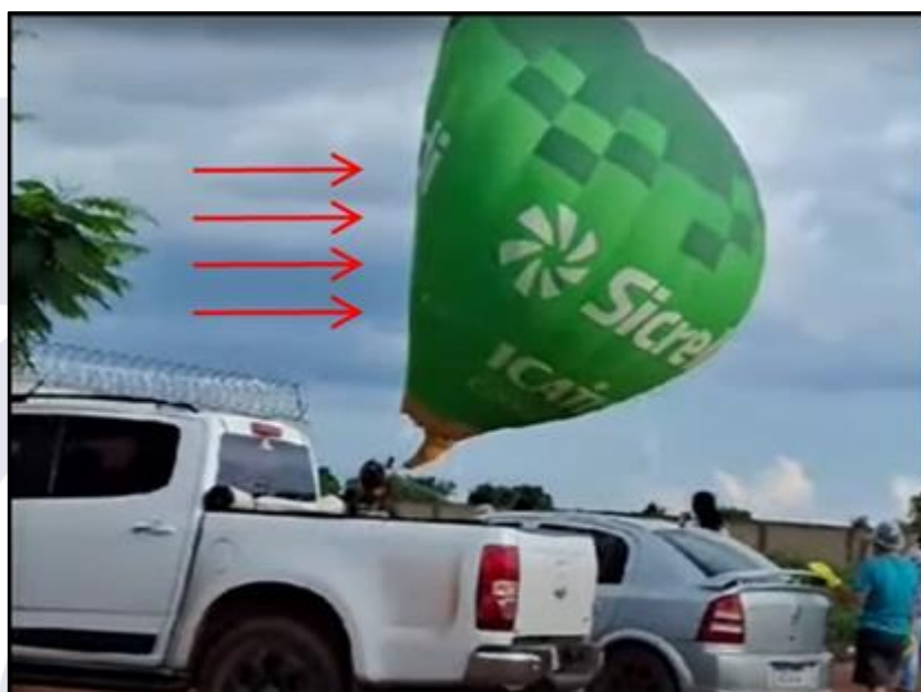
Figura 2 - Momento em que uma rajada de vento teria ocasionado a ruptura da fita de ancoragem.
