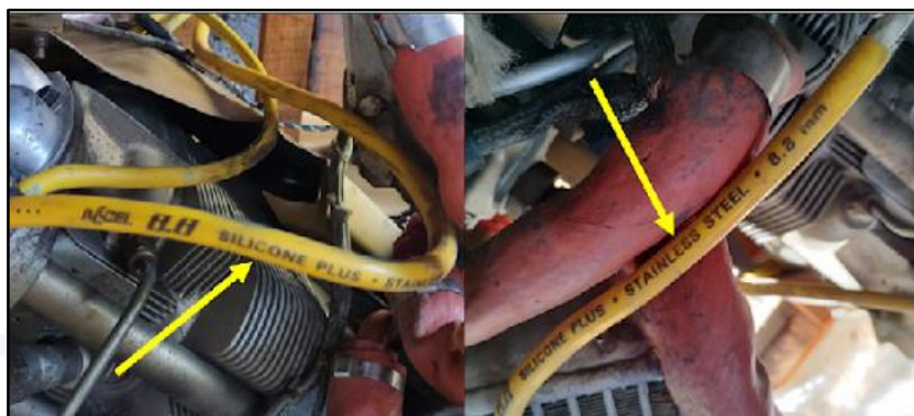
Figura 9 - Cabos de vela utilizados no motor da aeronave.
