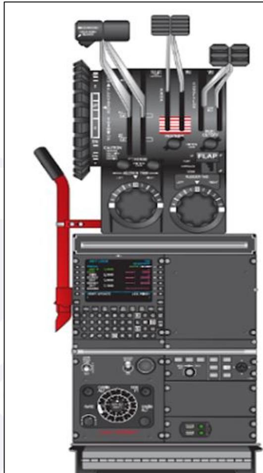
Figura 8 - Alavanca de acionamento em emergência destacada em vermelho (*LANDING GEAR ALTERNATE EXTENSION*).
