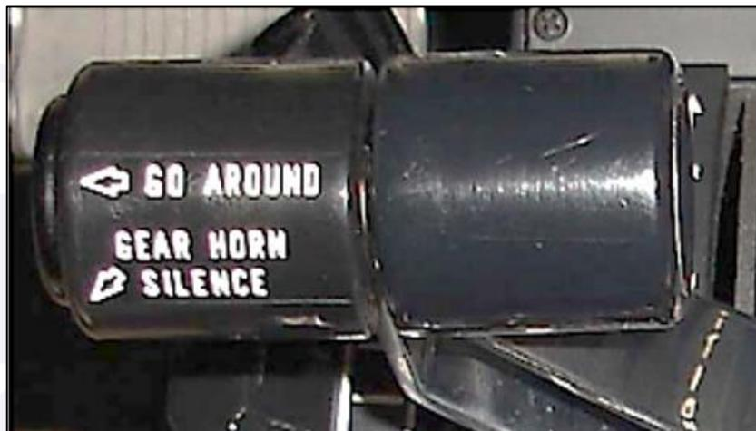
Figura 13 - Botão silenciador da buzina de configuração de trem de pouso.
