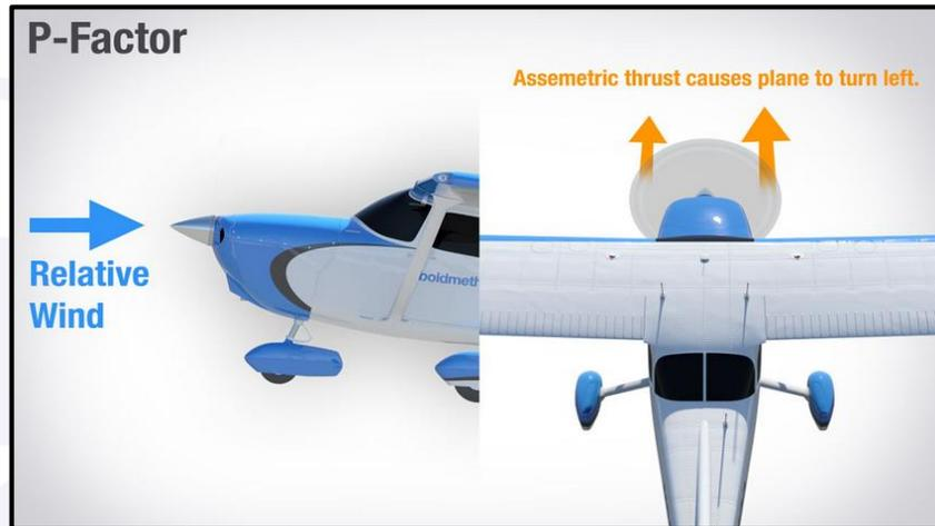
Figura 58 - “*P-Factor*” gerando assimetria de tração em aeronave monomotora a hélice. Fonte: imagem do site [www.boldmethod.com](http://www.boldmethod.com).
