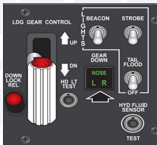
Figura 10 - Seletora de posição do trem de pouso e as luzes indicadoras da posição do trem.
