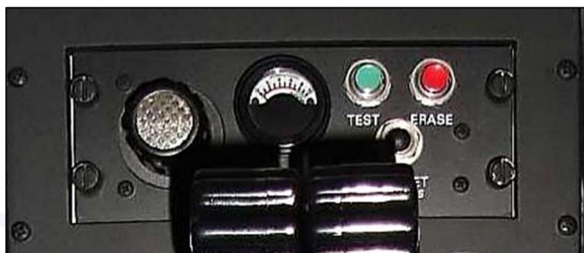
Figura 20 - Unidade de controle do CVR instalado.
