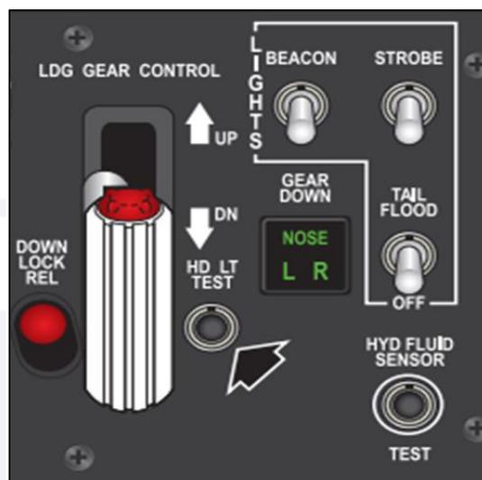
Figura 12 - Botão *HD LT TEST* utilizado para o cheque das luzes de controle vermelhas da alavanca do trem de pouso.
