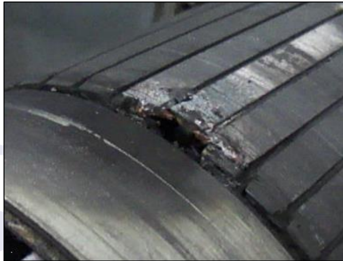
Figura 4 - Danos internos observados no gerador direito.
