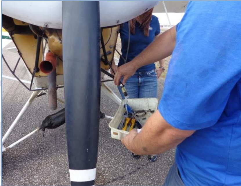
Figura 4 - Ventilação da linha de combustível.
