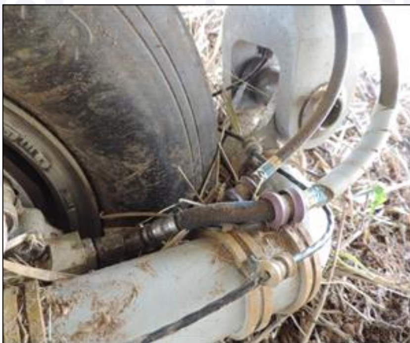
Figura 12 - Linha de alimentação hidráulica e nitrogen vent line do sistema de freios.
