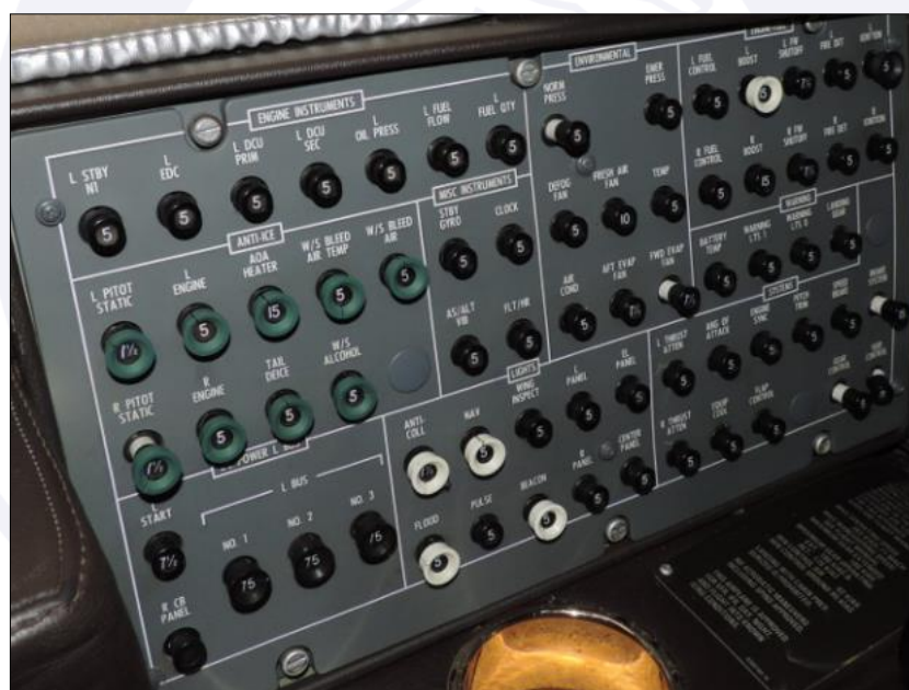
Figura 8 - Painel de disjuntores esquerdo.
