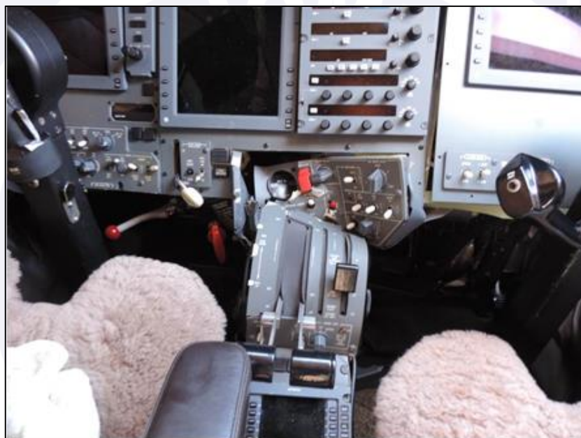
Figura 6 - Deformações no painel da aeronave e no console de manetes. O manete do motor direito já aparece reposicionado após a ação da equipe de bombeiros.
