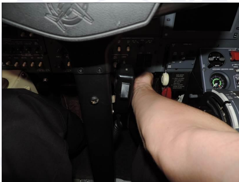
Figura 17 - Simulação do acionamento do punho do freio de emergência.
