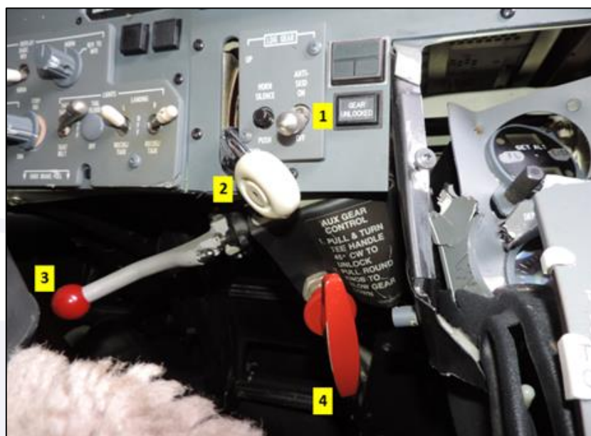
Figura 7 - (1) interruptor do anti-skid na posição OFF; (2) alavanca de comando do trem de pouso na posição embaixo; (3) alavanca de acionamento do freio de emergência; e (4) alavanca de baixamento do trem de pouso por emergência ( auxiliary gear control ).
