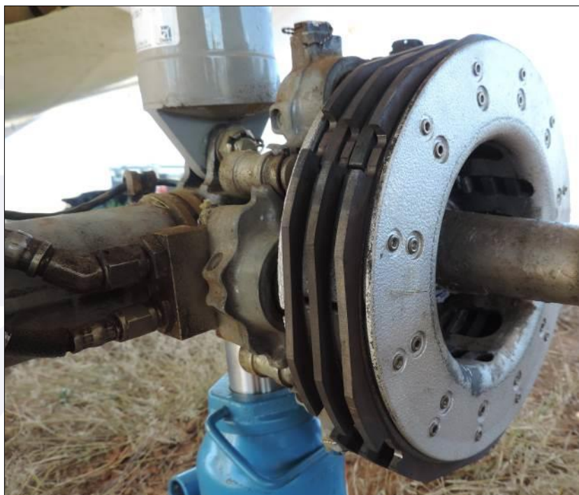
Figura 19 - Conjunto de freio esquerdo e linhas de alimentação hidráulica e pneumática.
