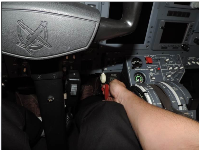
Figura 16 - Visualização da alavanca de acionamento do trem de pouso por emergência pelo piloto posicionado no assento da esquerda.
