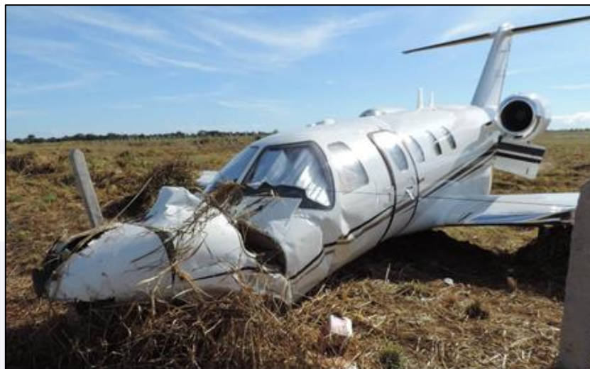
Figura 5 - Danos à seção dianteira da aeronave.
