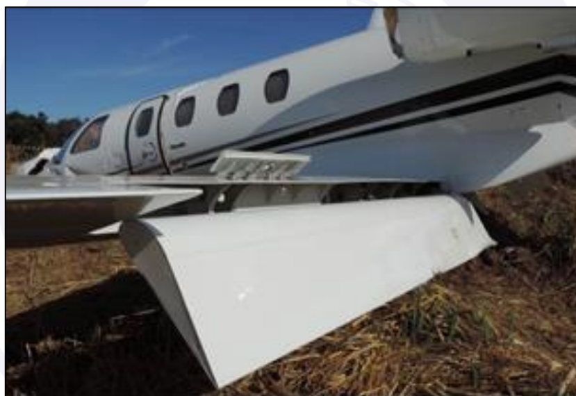
Figura 10 - Configuração de flaps em 60° e speed brake aberto - asa esquerda.
