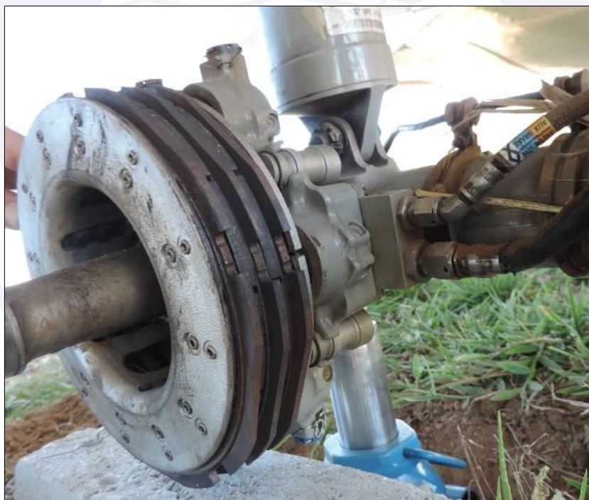
Figura 20 - Conjunto de freio direito e linhas de alimentação hidráulica e pneumática.
