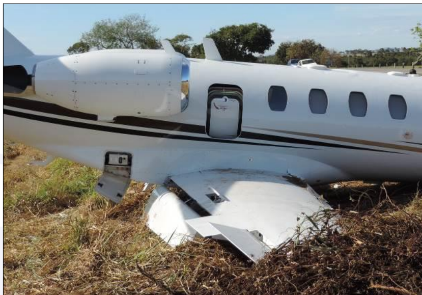
Figura 11 - Configuração de flaps em 60° e speed brake aberto - asa direita.
