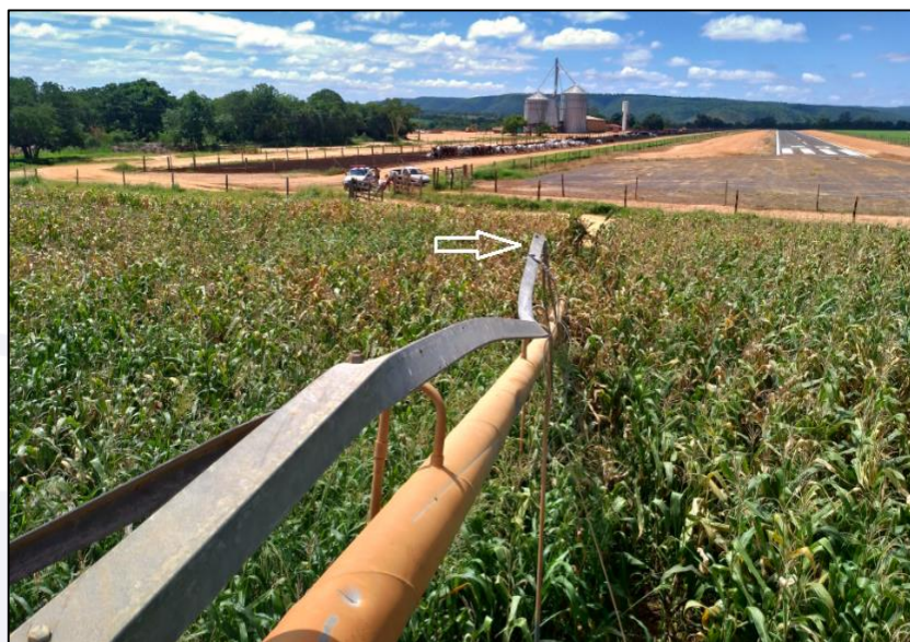
Figura 1 - Vista do último "braço" do pivô, caído sobre a plantação.
