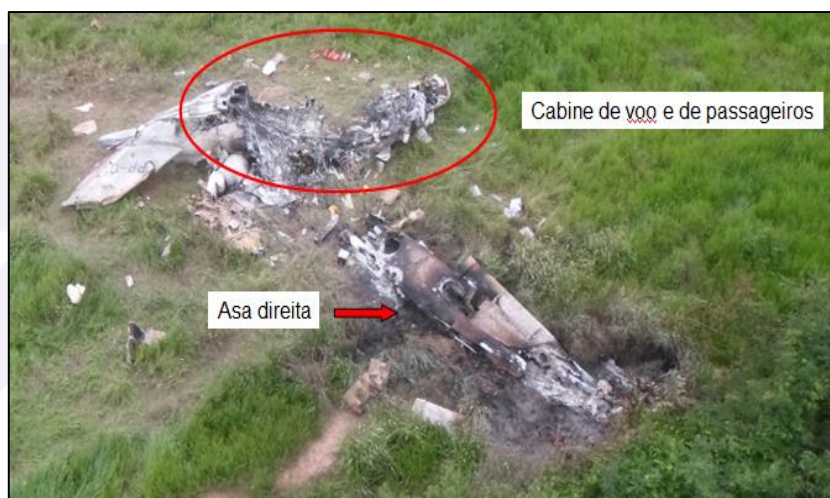
Figura 7 - Vista dos destroços, evidenciando as áreas mais atingidas pelo fogo.
