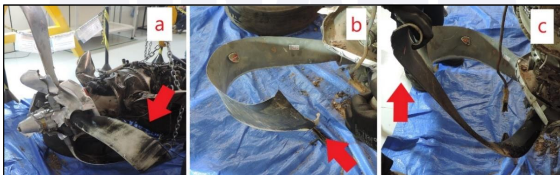
Figura 10 - (a) hélice, aspecto geral e marcas perpendiculares (b) ponta de pá seccionada pelo impacto contra árvore (c) ponta de pá dobrada.
