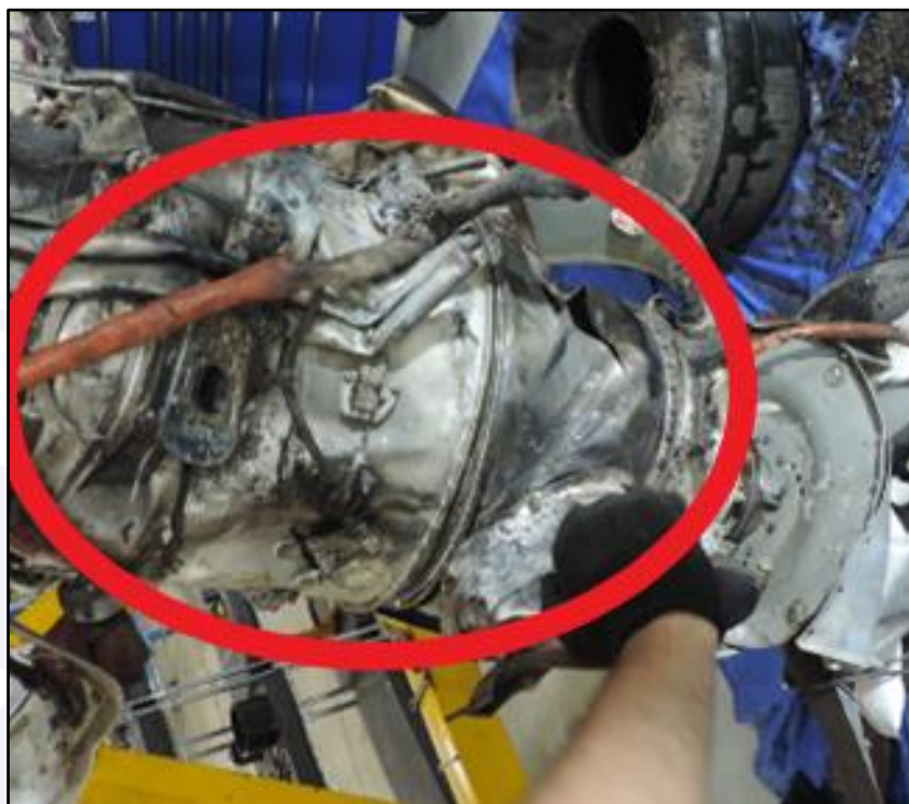
Figura 11 - Danos por flambagem.
