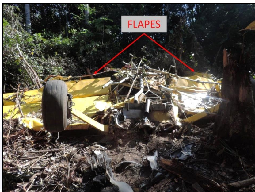
Figura 2 - Seção dianteira da aeronave enterrada no solo e posicionamento dos flapes.
