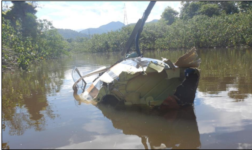
Figura 3 - Visão geral dos danos causados ao helicóptero (detalhe das torres da linha de transmissão ao fundo).
