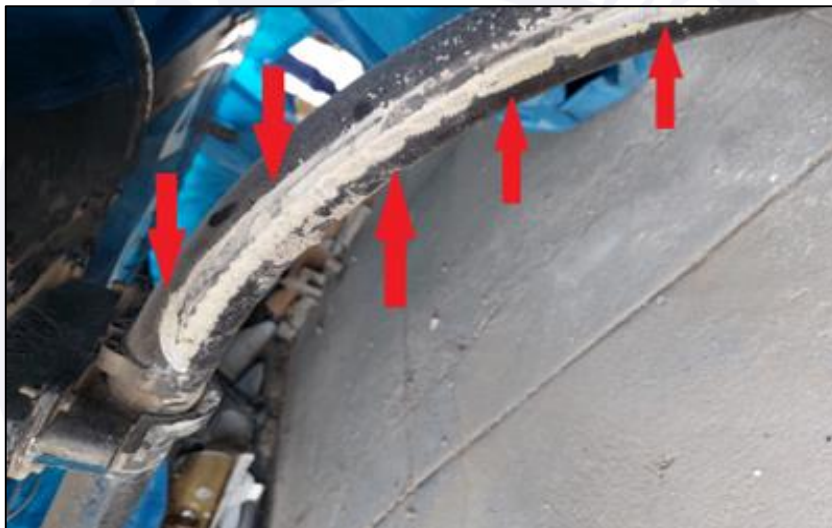
Figura 4 - Marcas de impacto contra os cabos da linha de transmissão.
