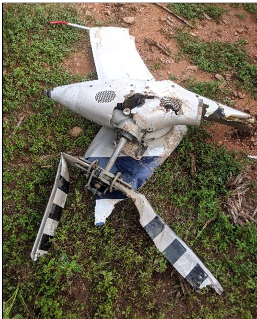
Figura 28 - Vista do rotor de cauda e da caixa de transmissão.
