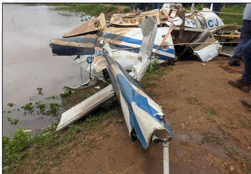
Figura 27 - Danos ao estabilizador horizontal esquerdo, com seccionamento do cone de cauda e do eixo de transmissão do rotor de cauda.
