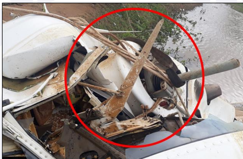
Figura 21 - Detalhe do corta fios inferior da aeronave sem vestígios de contato com o cabo para-raios.
