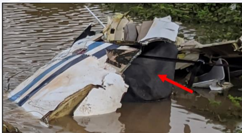
Figura 29 - Destroços com destaque para o tanque de combustível da aeronave.
