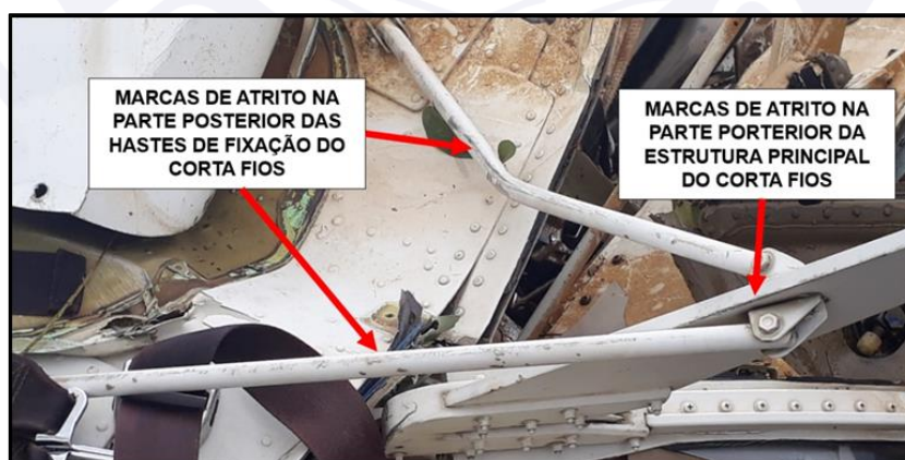
Figura 25 - Estado geral do corta fios superior.
