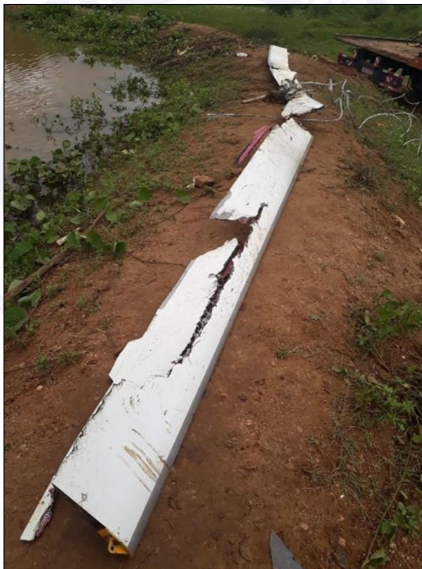
Figura 19 - Vista das duas pás do rotor principal.
