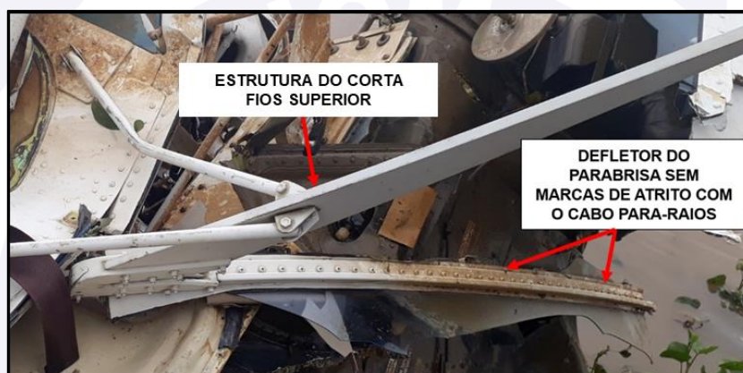
Figura 24 - Vista geral do corta fios superior com o defletor central (montante central) do para-brisas.
