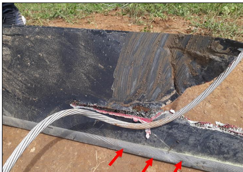
Figura 18 - Marcas de contato (ranhuras) entre o cabo para-raios e o bordo de ataque de uma das pás do rotor principal.
