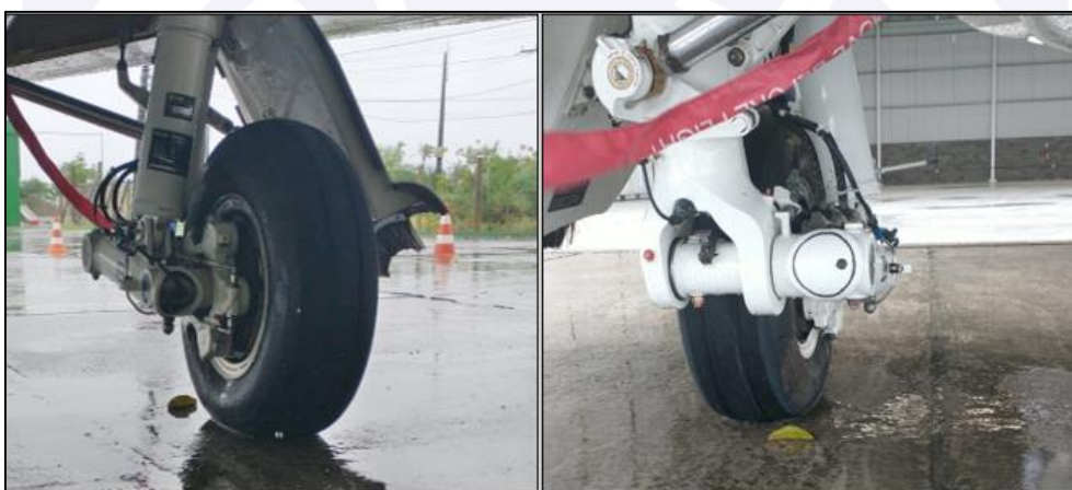
Figura 8 - Estado geral do pneu do trem de pouso principal direito (vistas dianteira e traseira).
