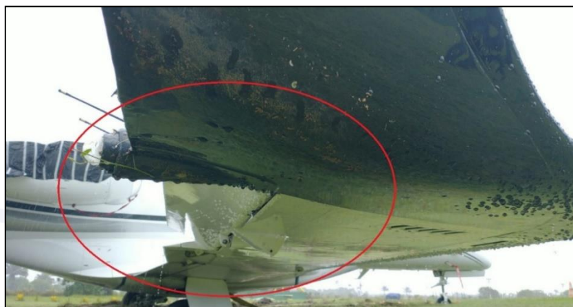
Figura 2 - Danos na ponta da asa direita.
