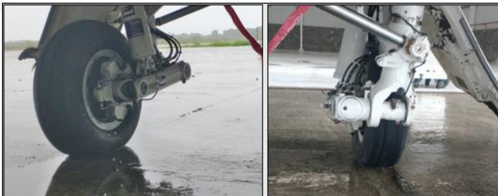
Figura 7 - Estado geral do pneu do trem de pouso principal esquerdo (vistas dianteira e traseira).
