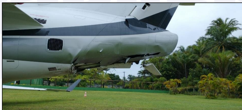
Figura 3 - Danos no cone de cauda.
