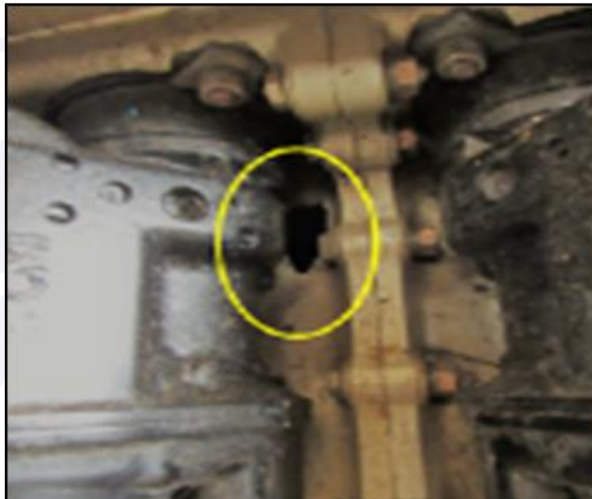
Figura 2 - Buraco na carcaça do bloco do motor próximo ao cilindro nº 1.
