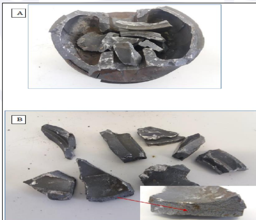
Figura 5 - Vista geral do pistão e fragmentos. A seta vermelha indica fraturas pelo mecanismo de sobrecarga.
