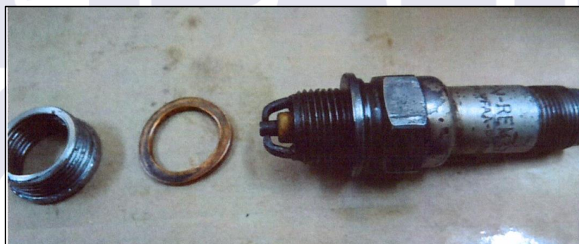
Figura 4 - Vista geral da vela inferior, após remoção da bucha.
