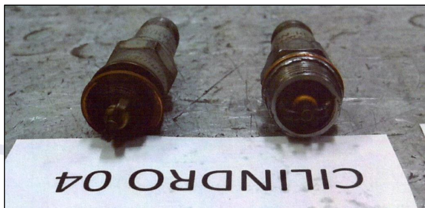
Figura 3 - Vista geral das velas do cilindro nº 4. Observa-se uma bucha na rosca da vela à direita.
