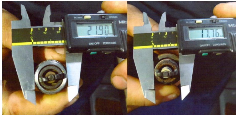
Figura 6 - Medida externa do diâmetro da bucha e do diâmetro da vela.
