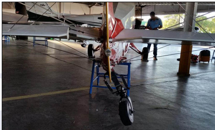
Figura 5 - Detalhe do dano no cone de cauda/bequilha.
