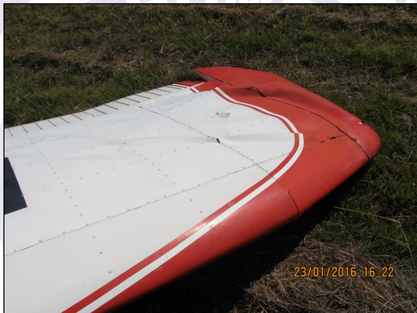
Figura 3 - Detalhe do dano na ponta da asa esquerda.
