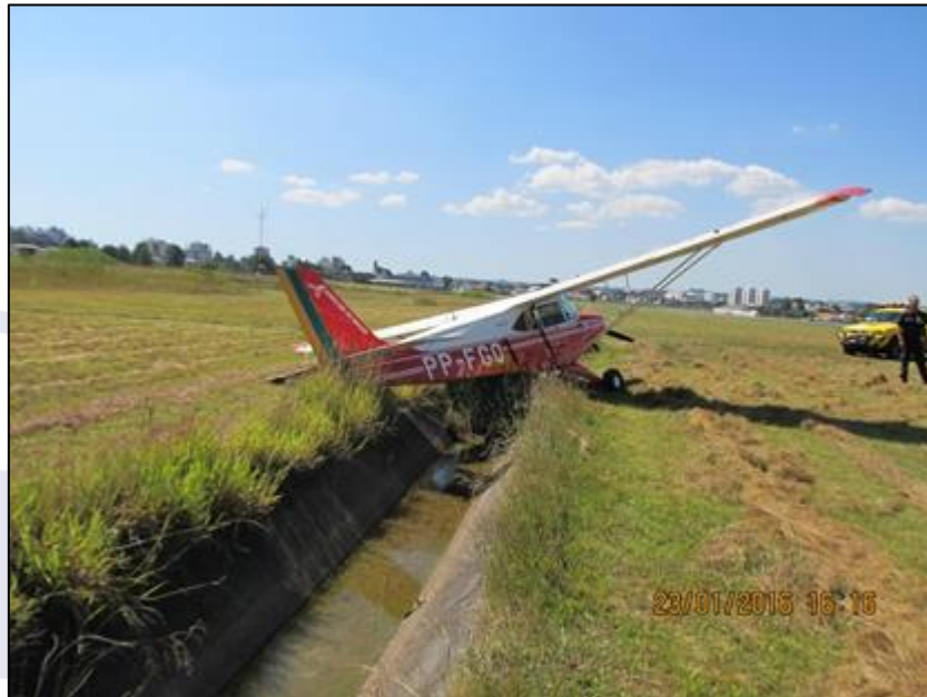
Figura 2 - Aeronave parada na valeta de drenagem de águas pluviais.
