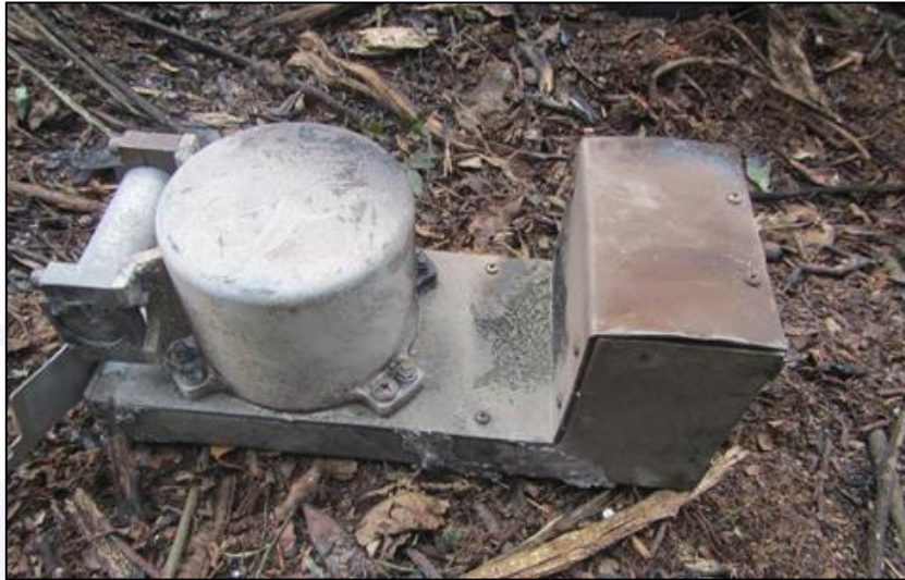
Figura 3 - Imagem do CVR registrada no local do acidente.
