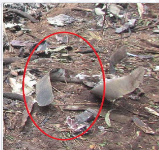
Figura 13 - Imagem de um dos conjuntos de hélice. No destaque em vermelho, uma de suas pás deformada na direção do sentido de voo.
