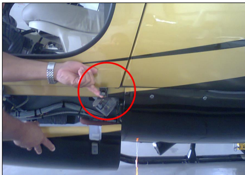
Figura 16 - Alinhamento da fenda do fecho da carenagem inferior com a caixa de acrílico dos microcontactores do TWIST GRIP (foto de helicóptero do mesmo modelo).
