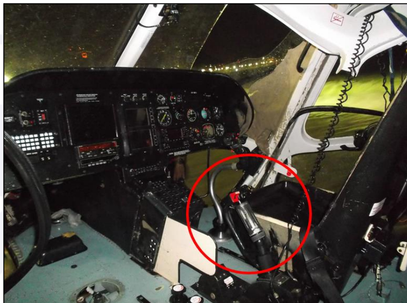
Figura 13 - Imagem da cabine de pilotagem, logo após a remoção da aeronave do mar, com destaque para o comando coletivo na posição totalmente puxado.
