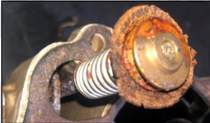
Figura 2 - Corrosão galvânica severa no Conjunto do Êmbolo da Bomba ( Pump Plunger Assembly ).
