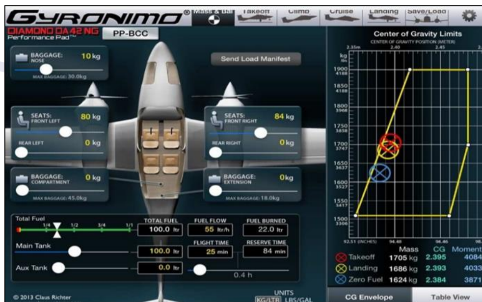
Figura 2 - Cálculo do peso e balanceamento conforme programa do fabricante.
