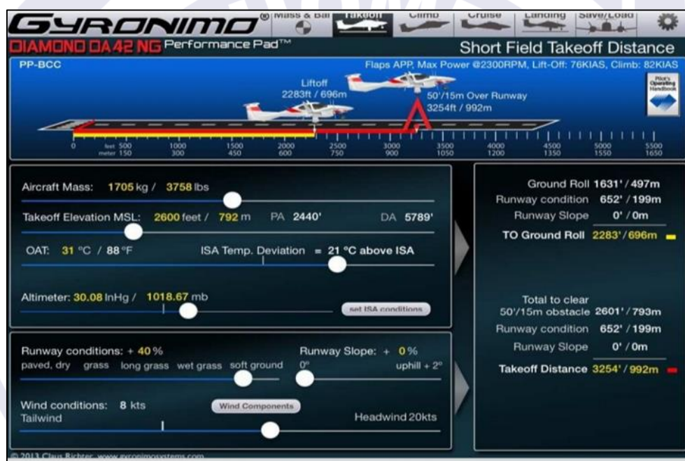
Figura 5 - Cálculo do comprimento mínimo de pista para decolagem.
