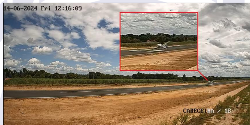
Figura 3 - Imagem em destaque do toque da asa e do intradorso do profundor direito na pista.
