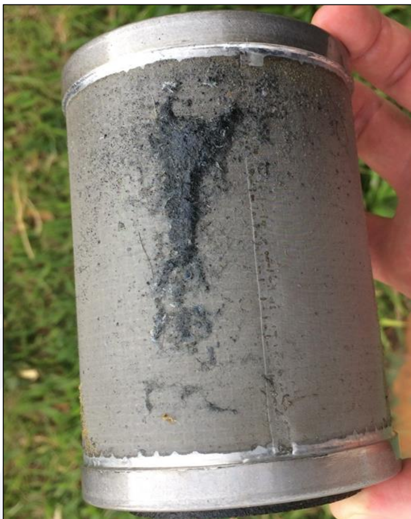
Figura 4 - Detritos encontrados no filtro de combustível de célula.
