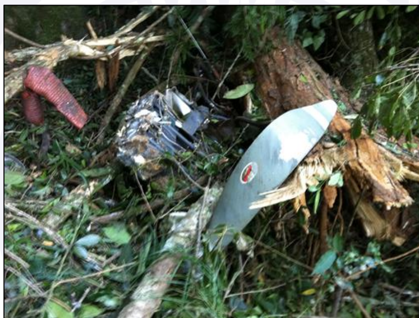
Figura 2 - Condição em que foram encontrados o motor e a hélice direitos.
