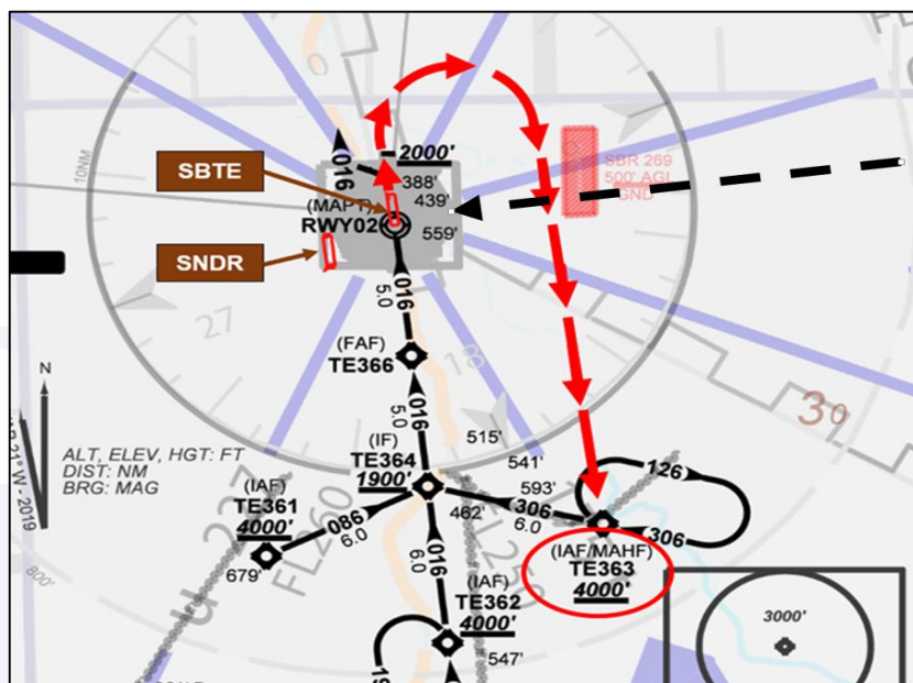
Figura 4 - Trajetória prevista (setas vermelhas) para o caso de arremetida na MDA do IAC RNAV RWY 02 de SBTE e setor de aproximação do PP-ASD (seta preta).
