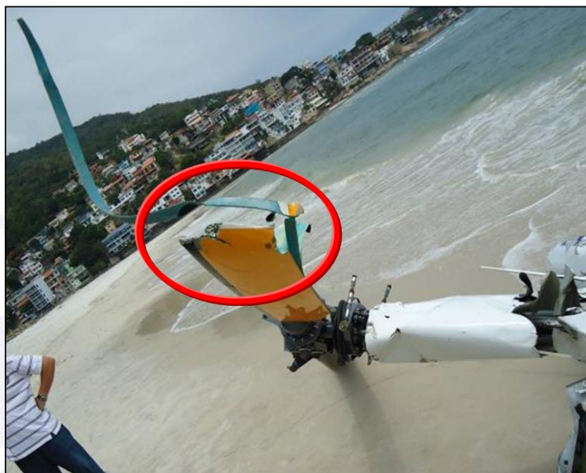
Figura 8 - Detalhe de uma das pás com quebra perpendicular à sua extensão.
