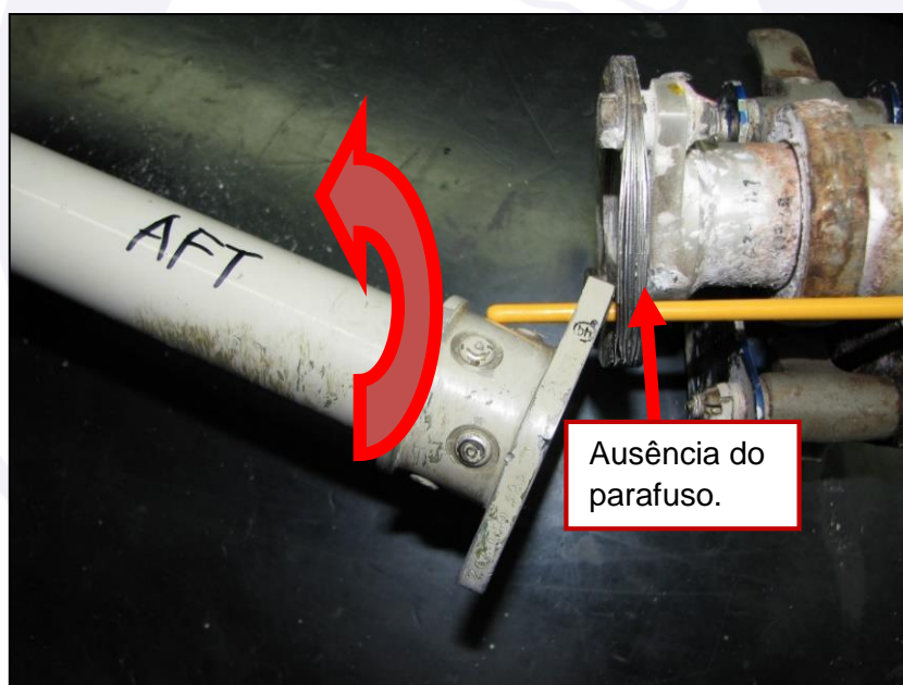
Figura 27 - Movimento do eixo depois da saída do 1º parafuso de fixação do eixo.
