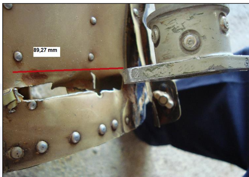
Figura 28 - Dano causado ao cone de cauda pelo eixo de acionamento.
