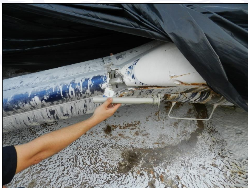
Figura 10 - Driveshaft Assy , arremessado em voo.
