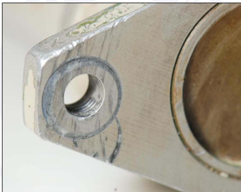
Figura 25 - Furo #1 com marcas da arruela.
