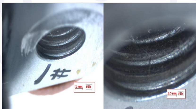
Figura 23 - Marcas de rosca do parafuso que saiu primeiro do flange de fixação.
