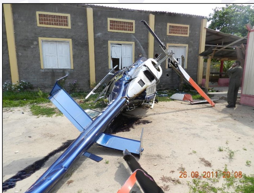
Figura 5 - Distribuição concentrada dos destroços.
