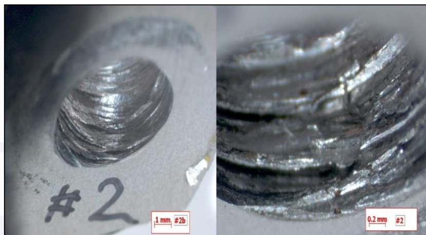
Figura 24 - Interior do furo do flange, com marcas de deformação por arrancamento por sobrecarga do segundo parafuso.
