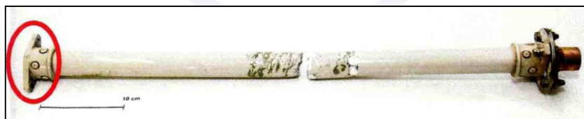
Figura 22 - Driveshaft Assy e Thomas Coupling (círculo vermelho) enviado para análise.
