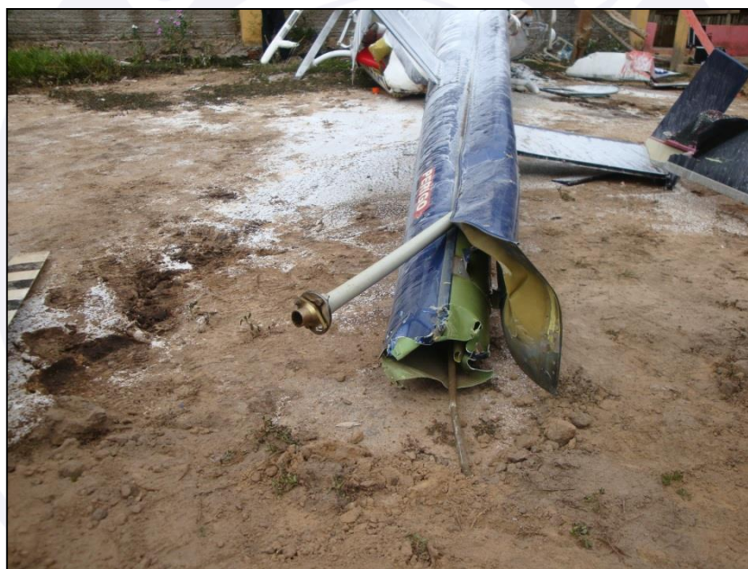
Figura 8 - Cone de cauda cisalhado pelo rotor principal.
