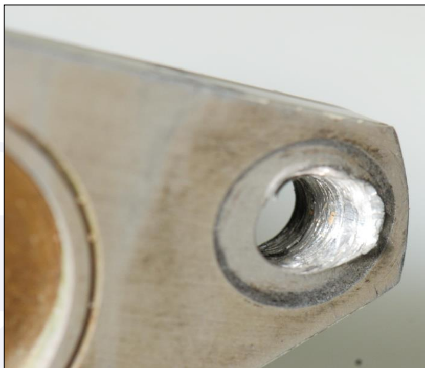
Figura 26 - Furo #2, com marcas de bearing .
