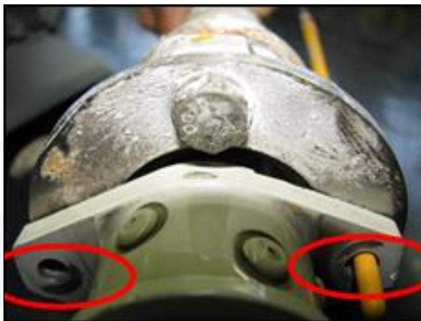
Figura 17 - Posição dos parafusos que se soltaram.
