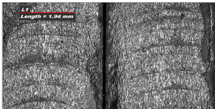
Figura 85: PT-UZI. Imagem coletada do Laudo Técnico relativo ao acidente com a aeronave. Fotoestereoscopia representativa da região de propagação de trinca evidenciando a presença de marcas de praia típicas de falha por fadiga.
