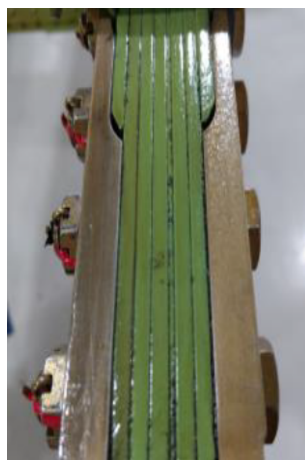
Figura 13: Detalhe do pacote de chapas que compõem as mesas (chapas mesa) das longarinas principais (longarinas dianteiras).
