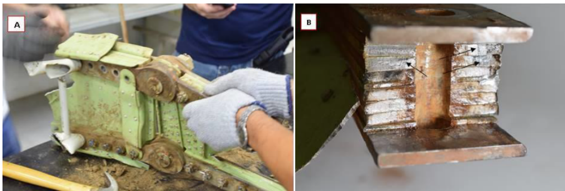
Figura 69: PT-UPG. (A) Vista geral do componente durante sua desmontagem. (B) Detalhe da região fraturada em serviço, após a remoção do prendedor de 1/2 pol. Observam-se corrosão na superfície de fratura e marcas de praia, indicativas de fadiga (setas).
