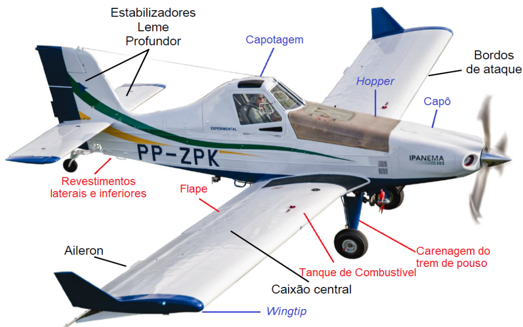
Figura 8: Alguns materiais empregados na fuselagem de um Ipanema EMB-203. Preto - Alumínio 7475; Vermelho - Alumínio 2024; e Azul - Fibra de Vidro.
