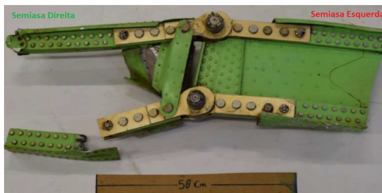
Figura 58: PT-UZI. Seção do caixão central das longarinas das semiasas direita (fraturada em voo) e esquerda.
