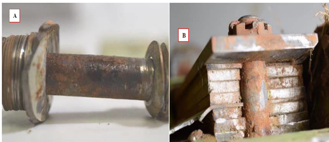
Figura 71: PT-UPG. (A) Prendedor de 1/2 pol removido da região da fratura apresentando corrosão superficial generalizada. (B) Detalhe da seção de fratura na região do 5º furo de 1/2 pol.
