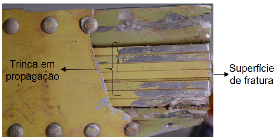
Figura 66: PT-UKZ. Trincas secundárias em propagação nas chapas da mesa inferior da longarina, paralelas à superfície de fratura principal.
