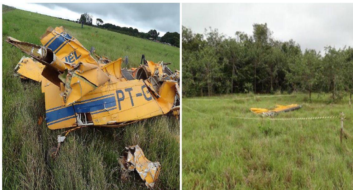
Figura 28: PT-GSB. Foto tirada no local do acidente. À esquerda, destroços principais da aeronave. À direita, detalhe da asa direita da aeronave, encontrada a 200 metros de distância dos destroços em relação à trajetória do voo
