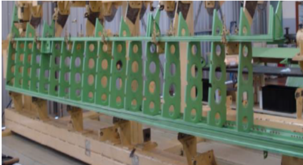
Figura 9: Detalhe da longarina principal (frontal) e secundária (traseira), unidas pelas nervuras.
