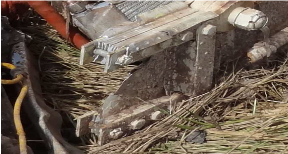
Figura 29: PT-GSB. Foto tirada no local do acidente. Região da longarina da asa direita fraturada em voo.
