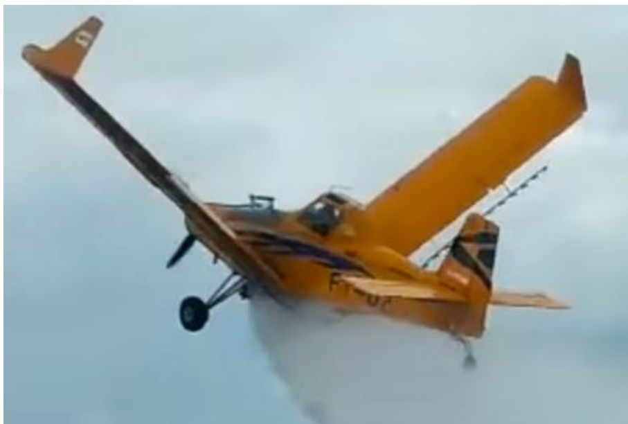
Figura 134: Imagem de um Ipanema PT-UZI durante evento catastrófico de fratura das longarinas das asas, após um alijamento de volume do tanque de produtos.
