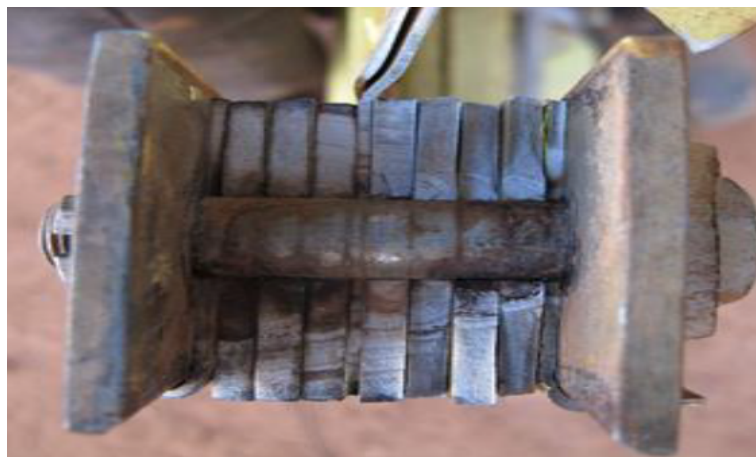
Figura 52: PT-ULQ. Indicação macroscópica das marcas de praia de fadiga da mesa inferior da longarina da semiasa esquerda.
