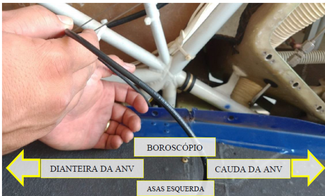
Figura 114: Caixaão Central - Boroscopia sendo feita através da janela de inspeção sobre a asa para visualização das faces superiores do pacote de chapas e dos parafusos de 3/16 pol.
