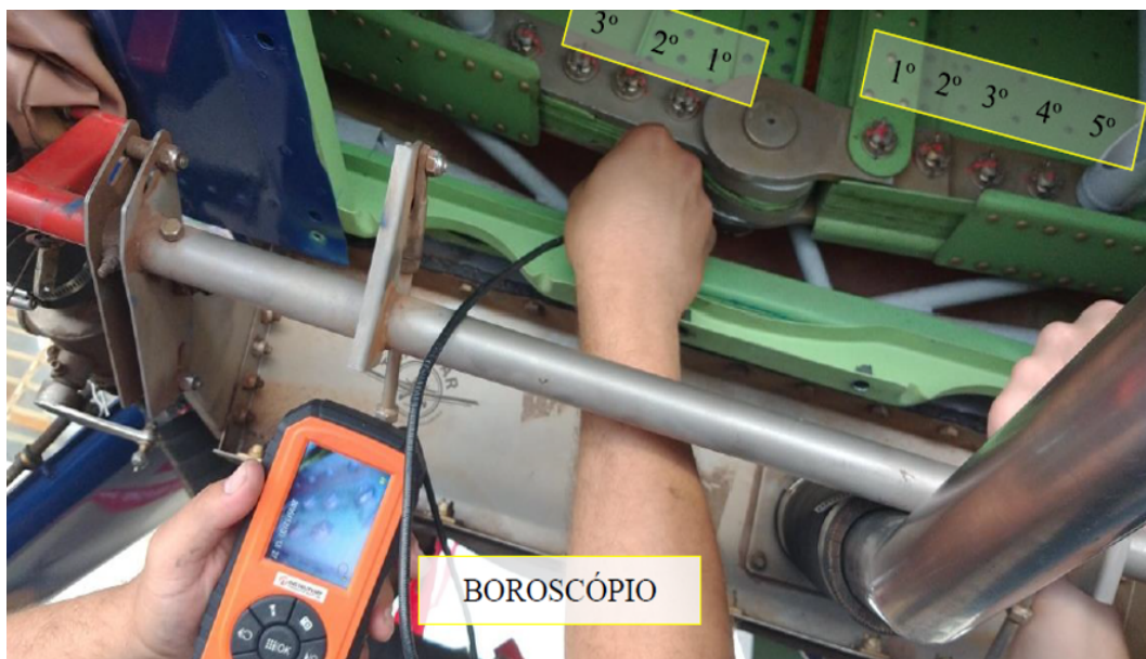
Figura 113: Boroscopia sendo feita através da janela de inspeção inferior.
