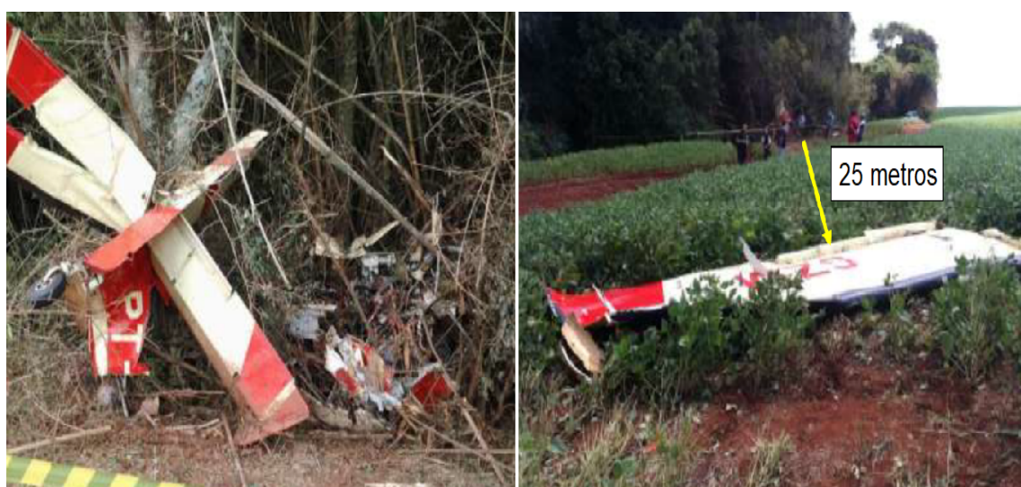
Figura 34: PT-GZM. À esquerda - destroços da aeronave. À direita - asa esquerda separada dos destroços principais a cerca de 25 metros.
