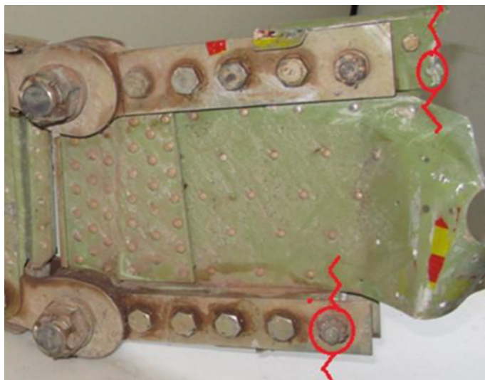
Figura 46: PT-USM. Região da fratura da mesa inferior (5º furo de 1/2 pol) e superior (2º parafuso de 3/16 pol) da longarina da semiasa esquerda.
