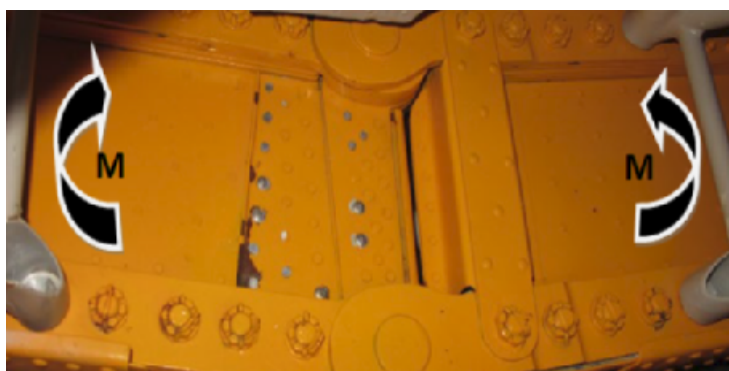
Figura 76: Representação do momento fletor que traciona mesa inferior das longarinas das semiasas RH e LH.
