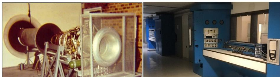
Figura 2: Motor Turbomeca Marboré IIC em banco de provas da década de 1960 e os bancos de prova de hoje.
