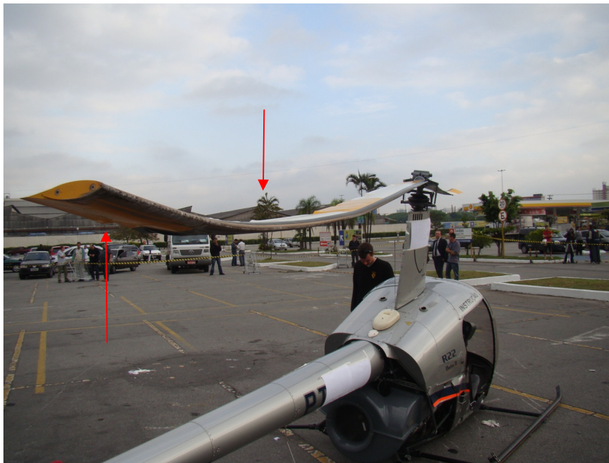
Figura 04: Detalhe do enflechamento das pás para cima.
