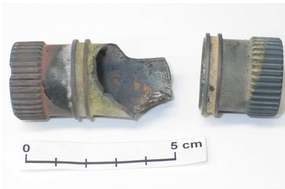
Foto nº14: situação do Pinion to Power Turbine Coupling .
