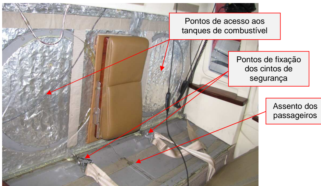
Foto nº18: acesso aos tanques pelo interior da aeronave.
