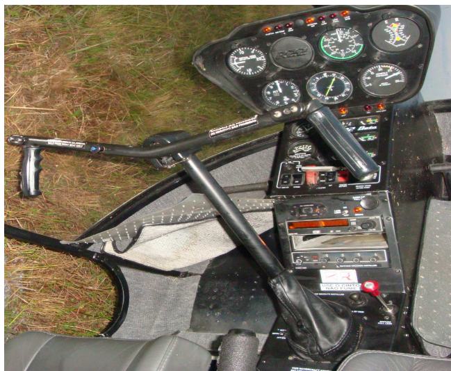
Foto nº 2 Posição dos punhos do cíclico na barra pendular.
