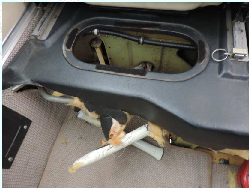
Figura 02 - Varão atuador do trem de pouso esquerdo quebrado atrás do assento esquerdo do piloto.
