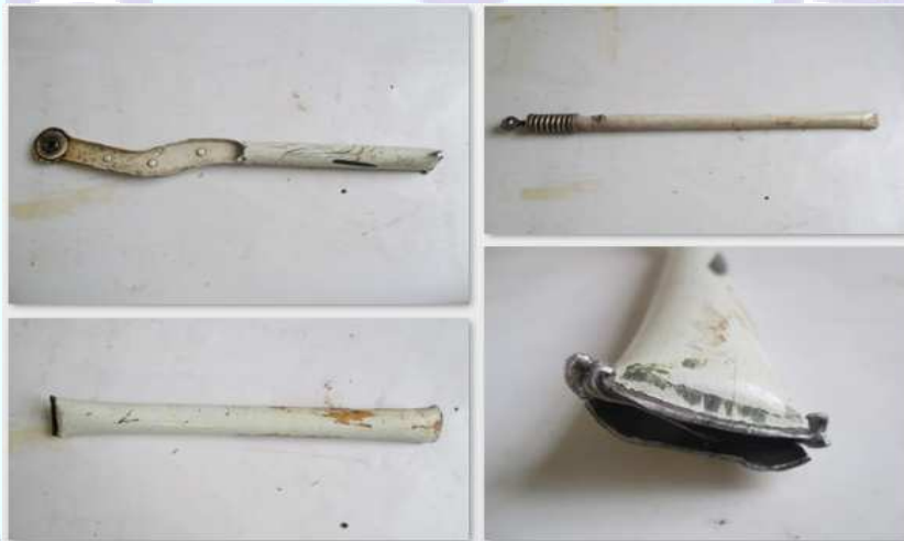
Figura 04 - Varão atuador do trem de pouso esquerdo fraturado ( Braze Assy – LH, P/N 35-815125-12-405).
