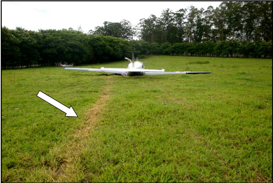
Foto 02 – Rastro deixado pelo combustível vazado do tanque esquerdo.
