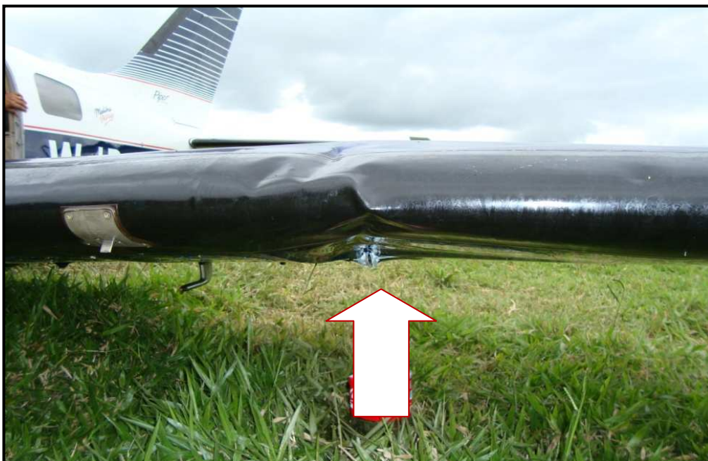
Foto 03 – Danos à asa esquerda, com vazamento de combustível do tanque.
