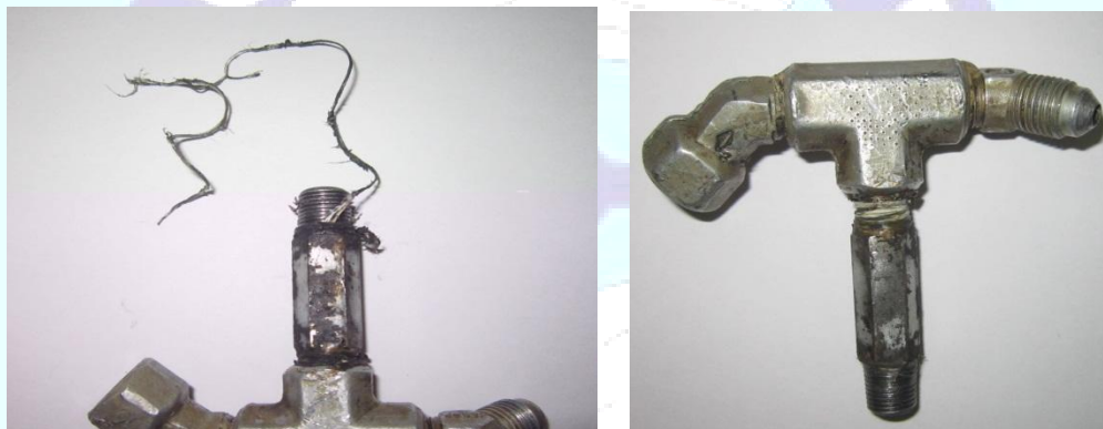
Figuras 3 e 4 - Nipple e conexão em "T", com veda rosca.
