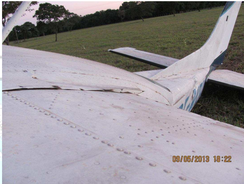
Figura 2 - Condições do revestimento da aeronave após dez anos estacionada no pátio do aeroporto.
