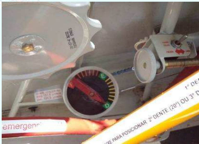
Figura 2 - Seletora do tanque de combustível selecionado para o tanque direito.
