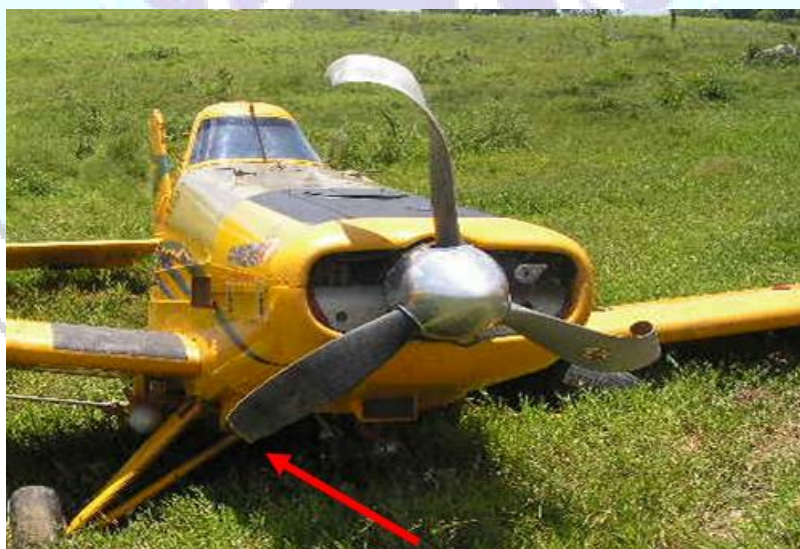
Figura 2 - Ponta da pá da hélice danificada.
