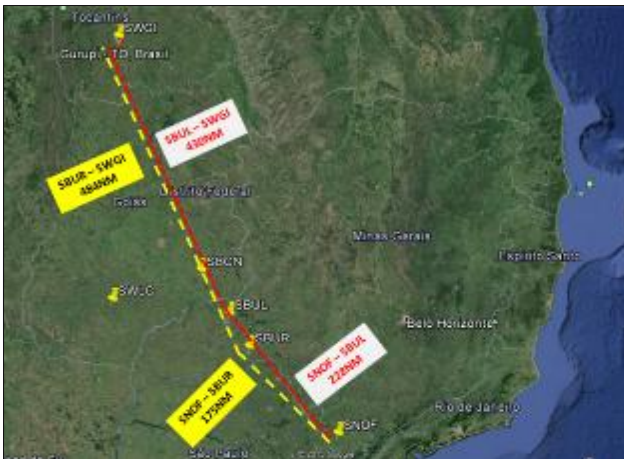
Figura 37 - Representação de rotas alternativas no trecho SNOF-SWGI. Em amarelo, a rota SNOF – SBUR – SWGI. Em vermelho, a rota SNOF – SBUL – SWGI.
