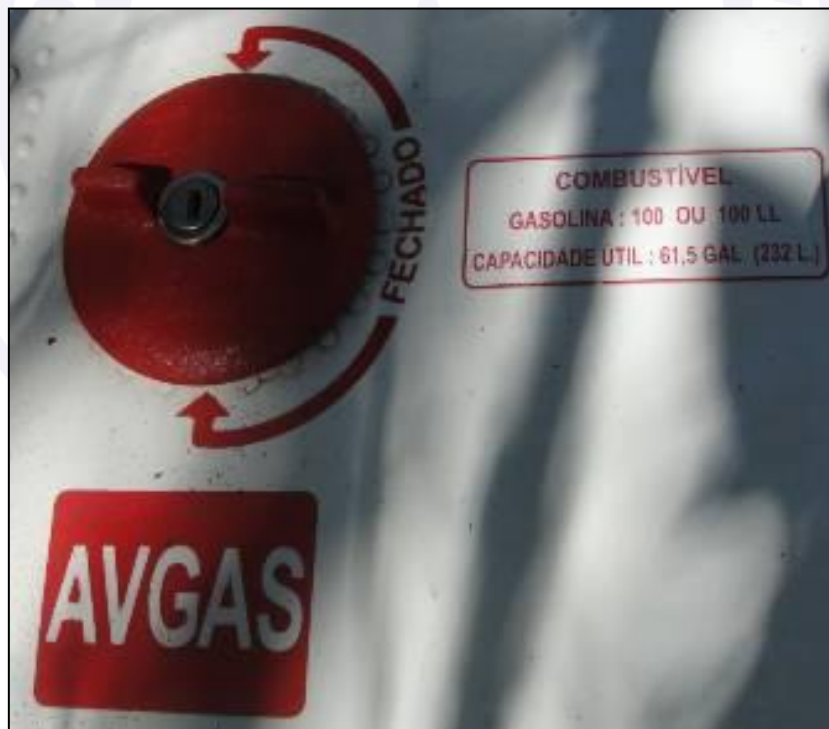
Figura 34 - Vista superior da asa direita. Indicação no bocal de abastecimento com a capacidade de combustível utilizável - 232 litros.
