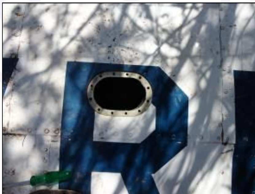
Figura 16 - Janela de acesso ao tanque da asa direita
