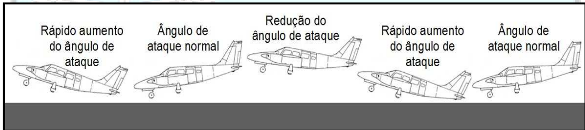
Figura 3: Representação do efeito de porpoising.
