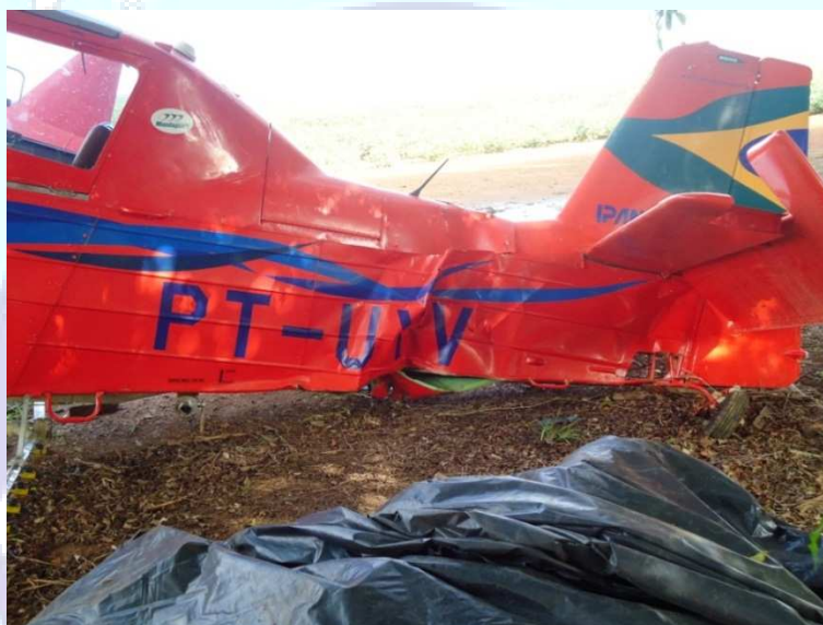
Figura 01 - Danos na cauda da aeronave.
