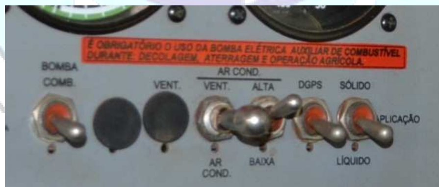
Figura 1 - Plaqueta no painel da aeronave alertando quanto ao uso da bomba elétrica
