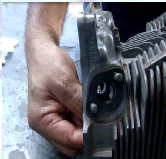
Figura 3 - Folga entre as válvulas e suas guias.
