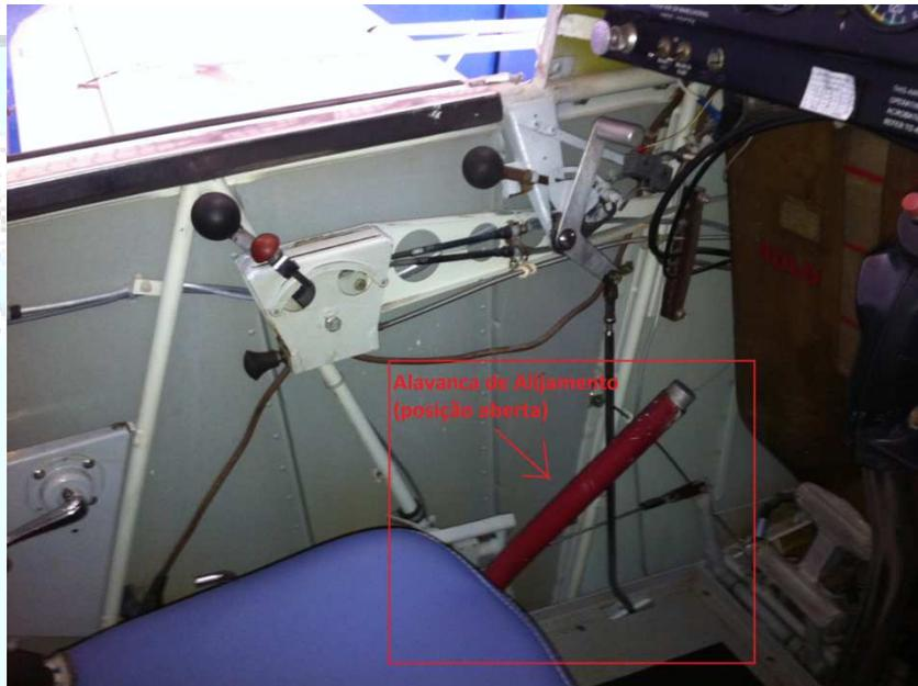
Figura 16 - Alavanca de Alijamento à Frente na Aeronave Pawnee.
