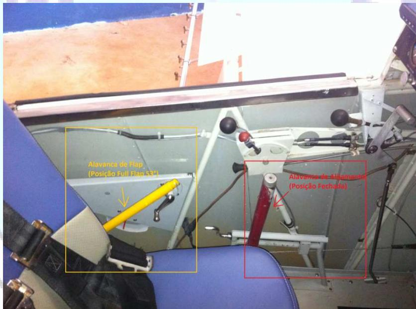
Figura 17 - Alavanca de Flapes à Retaguarda na Aeronave Pawnee.
