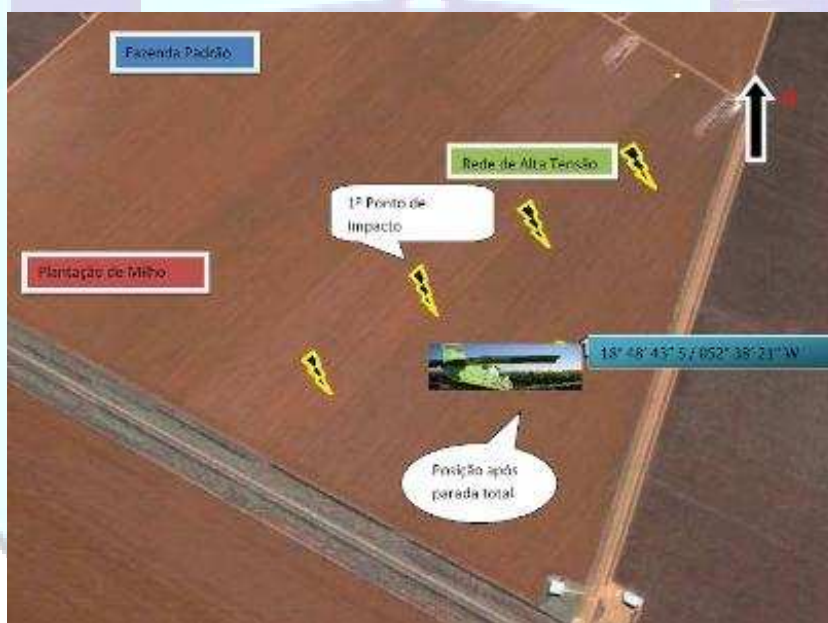
Figura 2 - Representação da rede de alta tensão em relação à área de aplicação.
