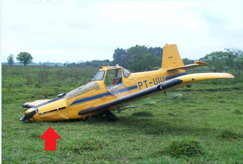
Figura 1 - Posição final da aeronave com trem de pouso quebrado.
