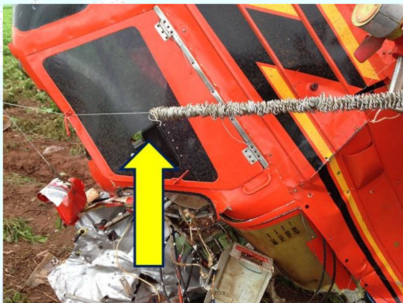
Figura 2 - Fio de alta tensão que amorteceu o impacto do avião contra o solo.
